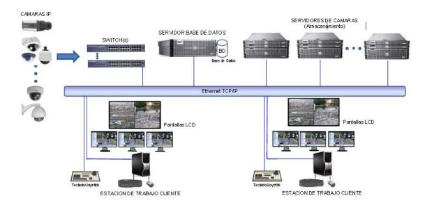
Una red LAN Ethernet exclusiva para los sistemas de seguridad, será implementada por el instalador de los sistemas de seguridad, por lo cual se debe contemplar si es necesario la instalación de backbone de fibra óptica para interconectar los Switch instalados en los cuartos de comunicación, interconectando además con el cuarto de monitoreo y el Centro de Computo Principal CCP.
