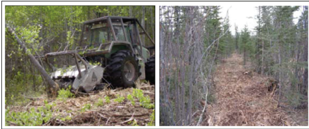
Figura 9. Izquierda: "mulcher" tumbando y triturando un árbol, derecha: línea preparada por "mulcher". Tomado de: www.emv.gov.yk.ca/oilandgas/pdf/bmp_seismic.pdf
