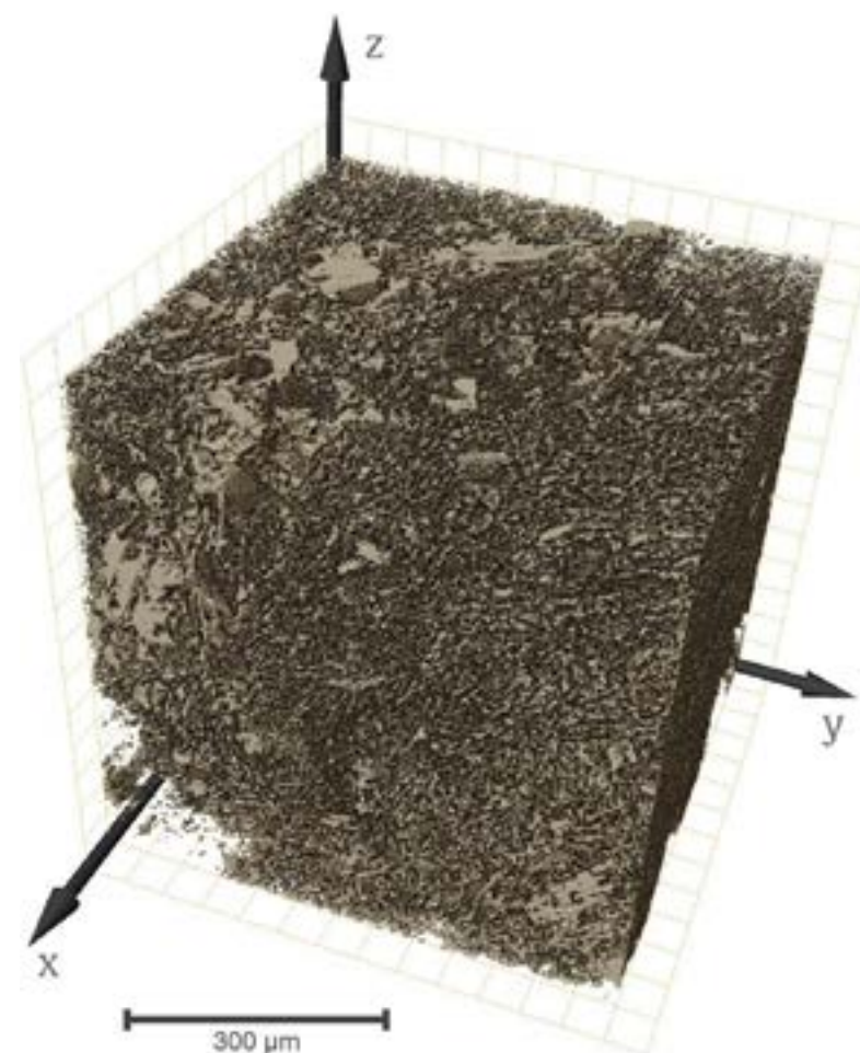
Figura 7. Modelo 3D de porosidad de una muestra geológica definida por microtomografía. Modificado de Denbury Resources Inc. 2024.
